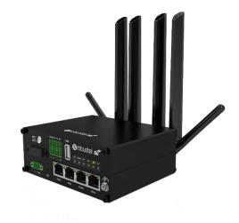
R5020 是鲁邦通推出的新一代 5G 高速工业路由器,支持独立组网(SA)和非独立组网(NSA),同时支持国内三大运营商的 5G 网络,在没有 5G 网络的情况下,也能使用 4G 和 3G 的网络,为物联网设备和传感器提供高带宽、低时延、高可靠的无缝无线网络连接。
